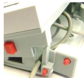
Schnittstellenanschlüsse auf der Rückseite des Terminals
